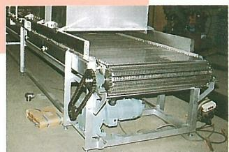
桃の缶詰生産工程に設置される加工機械です。桃割り機で2分割された桃は、カップダウン機によって同一面に並べられた後、ピーラーで表皮を除去します。特に桃割機はシェアNo.1を誇ります。
