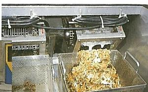
汚水計量装置と自動スクリーンを効率良くユニット化した省施行タイプで、し渣の管理・メンテナンスが容易。
