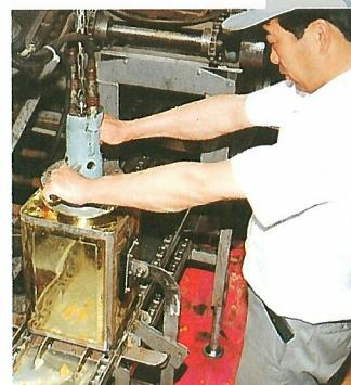
保存用18ℓ缶の果実缶容器内に残留している空気を押し出すエアー式の脱気装置です。
