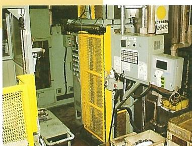
パケットに入れられた部品類を槽内に自動投入し、一定時間の洗浄後自動排出する機械です。
