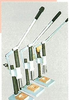
リンゴの外形を崩さずに、芯のみを抜き取る手動の機械です。
