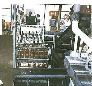
特殊なチェーン搬送機構と、ゴムロールによって、ブドウの皮を剥離します。
