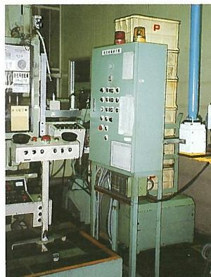
空の搬送箱(コンテナ)を自動供給し、ワークの定数計量後、自動移送・積下しをおこなう機械です。
